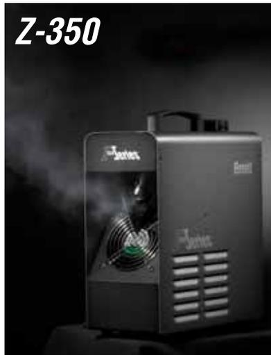
エアポンプ技術の採用により、 Fogリキッドを使用したドライヘイズの効果を出すことが可能になりました。高効率で極めて低い流体消費率により、1.3リットルタンクから最大出力で7時間以上使用することができます。ヒーターはセルフクリーニング機能を搭載し、DMX信号がOFFの時はセルフクリーニングを開始しスリープモードに入ります。また、ヒーター目詰まりの危険性を減少させるための、直径の大きなチューブが付属しています。
