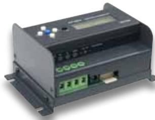
8チャンネルのDMX/EDX信号をアナログ信号(DC 0-10V)に変換し出力するアナログデコーダーです。8チャンネルのディマー、99ゾーン、6シーンを使用可能。ライトコンピューターEDXシリーズのECPシーンコントロールパネルとの接続が可能です。
