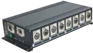
イーライト「DMXS4W」は1DMX入力を4つに分配することができるDMXスプリッターです。DMXS12(1990)信号を3pin入力端子から入力し、4つの3pin/5pin出力に分配と1つの5pin DMX THRUすることができます。入出力間および、出力-出力間は100%オプティカルアイソレーションとなっています。分配時に信号のブーストと再生機能を搭載。また各出力にシグナル・パワーインジケータを搭載。ターミネートボタンにより信号の終端処理ができます。
