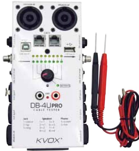
KVOX「DB-4U PRO」は、以下に対応するケーブルの導線・断線・接続ミス・グラウンドの有無を調べることが出来ます。また使用している乾電池のテストやグラウンド接続のテストを行うことができます。バナナプラグケーブルによりケーブルの傷などからテストも可能です。
