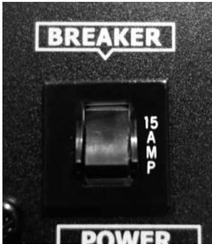
ブレーカをリセットする前に AC 電源を切断してください。同じタイプと定格のヒューズのみを交換してください。
