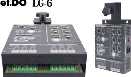
ネットドゥ「LG6」は 6CH DMX シグナルデコーダー + リレイアウトです。6ch の DMX 信号を 0 ~ 10V に変換します。無電圧リレイアウトも 6 系統標準で搭載しています。各チャンネル 8A 以内。ウォールマウント用のホール及びトラスやパトンに対してのリギングブラケットを標準で付属しております。
