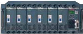
「DX-640」はモジュールタイプのDMX・アナログ両対応ディマーです。DMX6ch、それぞれ40Aまで(合計240A)C2/C3 リニア調光カーブを採用し、自動周波数センサーが50Hz/60Hzを判別し、自然な調光をおこないます。各チャンネルに高速マグネティック・ブレーカーを装備。41度を超えると4つのサーモファンが加熱時に自動動作します。75度を超えるとディマー動作停止 65度まで冷えるとリスタートします。セルフテスト機能 各チャンネルにプリヒート機能(0~6%) 調光オンオフの設定可。
