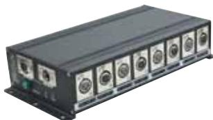
イーライト「DMXS4W」は 1DMX 入力を 4 つに分配することができる DMX スプリッターです。DMX512(1990) 信号を 3pin 入力端子から入力し、4 つの 3pin/5pin 出力に分配と 1 つの 5pin DMX THRU することができます。入出力間および、出力 - 出力間は 100% オプティカルアイソレーションとなっています。分配時に信号のブーストと再生機能を搭載。また各入出力にシグナル・パワーインジケータを搭載。ターミネイトボタンにより信号の終端処理ができます。
