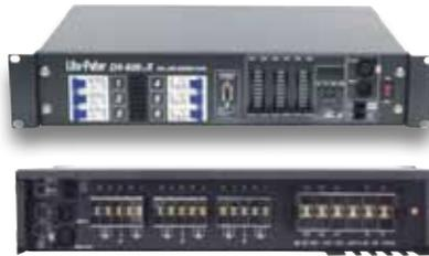
「DX-626」は調光フェーダーを搭載したスマートなディマーです。DMX6ch、それぞれ20Aまで(合計120A)C3 リニア調光カーブを採用し、自動周波数センサーが50Hz/60Hzを判別し、自然な調光をおこないます。各チャンネルに高速マグネティック・ブレーカーを装備。35度を超えると4つのサーモファンが加熱時に自動動作します。75度を超えるとディマー動作停止 65度まで冷えるとリスタートします。セルフテスト機能 各チャンネルにプリヒート機能(0~6%) 調光オンオフの設定可。
