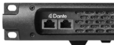
Ultimo 4x4 チップセットを採用し、Dante システムに簡単に参加できます。・最大 96KHz のデジタルオーディオ接続・リモート、ネットワークコントロール
