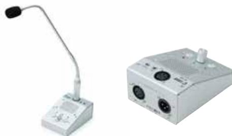
e-comm「DT-100」は2線式、シングルチャンネルのデスクトップステーションです。卓上だけでなく、底面には壁面取付用の穴を設けておりますので柔軟な設置が可能です。操作面は Mic Volume Call ボタンと非常にシンプルな構成で出来ており扱い易い仕様となっております。Talk ボタンは PTT・LATCH を任意で選択頂けます。※在庫限り
