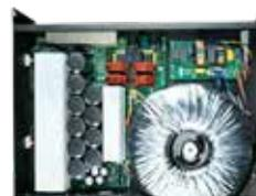
DRシリーズは、巨大な高耐久トロイダルトランスを中心に構築されています。このトランスは、急速なバーストパワーを実現し、ダイナミクスを向上させます。
