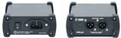
e-comm「PWS-24」は2線式インターカムシステムの電源供給ユニットです。ベルトパックおよびリモートステーションを24VDCで運用時、最大8台まで接続が可能です。サイズも非常にコンパクトで簡易インターカムシステムを構築するのに最適です。PW-10は2つのXLRアウトが備わっておりますので、2箇所へインターカム信号を送信できます。e-comm製品はPro Intercom製品、Clear-Com製品と互換性があります。
