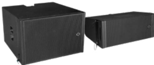
WLA210Aには、FIRを含む8つのDSPプリセットが搭載されています。EVO-Fold ウェーブガイドに直接接続された3インチボイスコイルのHFドライバーと2つの10インチLFウーファーで構成されるハイボックスはバイアンプ駆動となっています。
