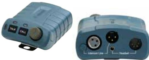
e-comm「BK101/4」は2線式のシングルチャンネルベルトパックです。XLR4ピンのヘッドセットコネクター以外に3.5mmヘッドセットコネクターも備っております。TALKボタンはPTT方式、ラッチ式を切り替えてご選択頂ける仕様となっておりますので、好みや用途に合わせたセッティングが可能です。外装はプラスチックを採用しておりますので非常に軽量で、腰元に装着しても重量を感じさせない設計となっております。
