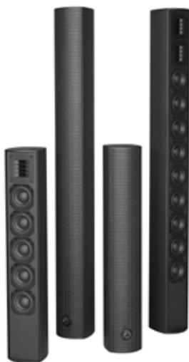
「SIGMA XV5 / XV9」は設備用スピーカーの定番モデル SIGMA シリーズを全面的にリニューアルしたカラムアレイスピーカーです。従来の SIGMA シリーズをベースに、フロントグリルやサポート材を新たにデザインし、シンプルな外観とサウンドを実現しました。新設計の mini EVO-Fold ウェーブガイドと、HF コンプレッションドライバを採用。SIGMA-XV5 は 1 基、SIGMA-XV9 は 2 基のコンプレッションドライバを搭載、mini EVO-Fold ウェーブガイドにより水平面と垂直面の両方において均一なカバレッジを提供します。U ブラケットが標準付属。箱から出してすぐ取り付けが可能です。SIGMA XV5 / XV9 は、システムを最大限に活用するための FIR プリセットがご利用いただけます。
