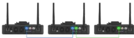
注意：カスケード接続された機器の間は、2 メートル以上離してください。標準 RJ45 ケーブル（最大 300m）
