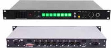
e-comm「TM-800」は2線式8chのメインステーションです。各チャンネル1つのXLRアウトを備えております。機能面では、ベルトパックやリモートステーションのTALKボタンをOFFにするRMKボタンや4ch分のIFB機能、音声ライン信号を入力するプログラムインプット、音声ライン信号を出力するアナウンスアウトを備えております。EIA規格に準拠しておりますので、既存のシステムラックに収納が可能です。
