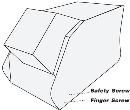
電源を抜いた状態で、2種類のネジをドライバーで外して下さい。
