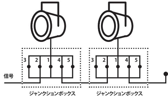
DMX512 コントローラーを直列に並べたユニットに接続します。DMX でフィクスチャーを制御するためには、DMX512 データリンクが必要です。器具には DMX データ入出力用の 3/5 ピン XLR コネクタがあります。各ユニットは 13 個の DMX チャンネルを持っていますので、DMX アドレスは (Nx1)+1、(Nx2)+1、(Nx3)+1 のように 1 ずつ増やしていきます。001 ~ 512 の範囲で任意の DMX アドレスを使用することができます。
