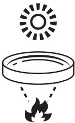
凸レンズは、虫眼鏡のように光を集中させます。決して光源を直視しないでください。網膜損傷の危険性・失明を招く恐れがあります。レンズ面を太陽やその他のフィクスチャーの強い光源に向けしないでください。強い光は、フィクスチャーの内部損傷を引き起こし、数秒以内にコンポーネントを溶かしたり、内部火災を発生させることがあります。日中の屋外で使用する場合は、照明器具の前面が遮光されているか、または太陽から遠ざかっていることを確認してください。
