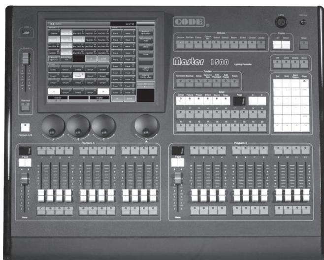
コード「Master」は、多彩な機能を搭載したライティングコンソールです。オプティカルアイソレートされた3ユニバース(最大1536ch)のDMX出力を備え、あらゆる種類の灯体を最大400ユニットパッチ可能です。1つのフィクスチャー辺り最大80チャンネルを使用できます。本体には10.4インチLCDタッチスクリーンディスプレイを備え、VGAインターフェースにより外部モニターを追加することができます。24のプレイバックフェーダーx30ページにより720のプレイバックを可能にします。400グループ・400プリセット
