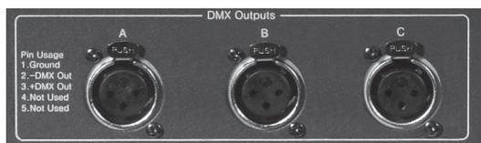
3 ユニバース DMX、各ユニバース 512 チャンネル出力可能です。A、B、C の出力ソケット上から直接 DMX を送ることができます。
