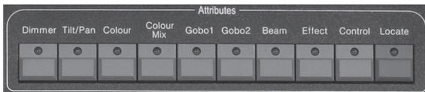
9つの属性キーと1つのLocateキーがこのエリアにあります。同じキーを押すと属性キーの2ページ目に移動し、他のチャンネルを表示します。各ページには、最大で3つのチャンネルを表示することができます。属性キーとそれに基づくA,B,Cホイールを使用してフィクスチャを制御することが可能です。
