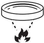
凸レンズは、虫眼鏡のように光を集中させます。決して光源を直視しないでください。網膜損傷の危険性 - 失明を招く恐れがあります。レンズ面を太陽やその他のフィクチャーの強い光源に向けしないでください。強い光は、フィクチャーの内部損傷を引き起こし、数秒以内にコンポーネントを溶かしたり、内部火災を発生させることがあります。日中の屋外で使用する場合は、照明器具の前面が遮光されているか、または太陽から遠ざかっていることを確認してください。
