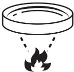
凸レンズは、虫眼鏡のように光を集中させます。決して光源を直視しないでください。網膜損傷の危険性・失明を招く恐れがあります。レンズ面を太陽やその他のフィクスチャーの強い光源に向けしないでください。強い光は、フィクスチャーの内部損傷を引き起こし、数秒以内にコンポーネントを溶かしたり、内部火災を発生させることがあります。日中の屋外で使用する場合は、照明器具の前面が遮光されているか、または太陽から遠ざかっていることを確認してください。
