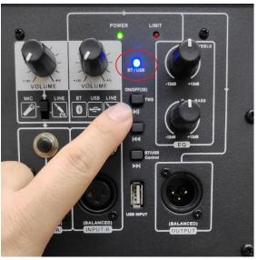
③ ランプが赤点灯となり、内部の音楽データの再生が自動的に開始されます。(下左図) なお、一時停止・再生、曲送り・戻しは出来ますが、早送り・巻き戻しは出来ません。 (下右図)
