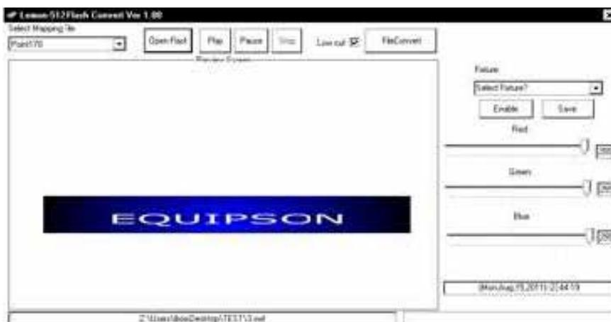
変換するファイルをロードした後、「FileConvert」ボタンをクリックすると、エクスポートファイルの1秒あたりのフレーム数を調整できるウィンドウが表示されます。1秒あたりのフレーム数は1～35フレーム/Sの範囲で調整できます。
