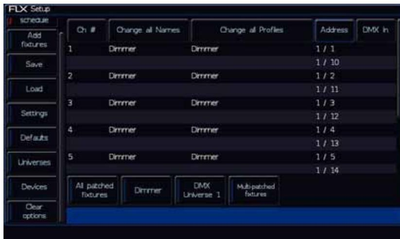
フェーダー 1 本のみを特定して、マルチパッチにする事も可能です。その場合は Address の行から、マルチパッチしたいアドレスを下の画像のアドレスナンバーを直接タッチします。下の画像では 1/1 をタッチしています。後の流れは上記と同じです。
